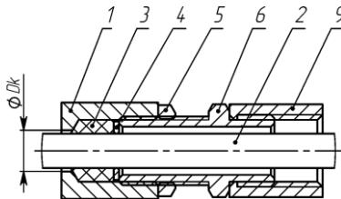
б) монтаж бронированным кабелем в кабельном вводе КВБ12
