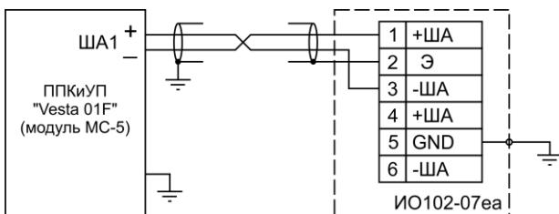
**Рисунок 6 -** Общая схема подключения извещателей ИО102-07ea в двухпроводную АЛС “ША” ППКиУП “Vesta 01F” или модуля “MC-5”.
