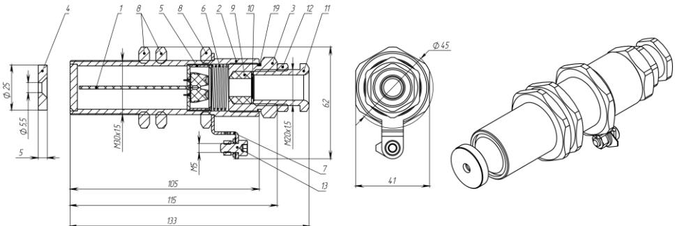
1 - плата; 2 - корпус блока датчика; 3 - переход; 4 - магнит; 5 - трубка; 6 - пружина; 7 - кольцо заземления; 8 - гайка; 9 - кольцо уплотнительное; 10 - шайба; 11 - кабельный ввод (KBO14 показан для примера, может отличаться в выбранной комплектации); 12 - стопорная гайка; 13 - винт заземления M5; 19 - кольцо уплотнительное.
