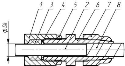
в) монтаж в трубной разводке с помощью штуцера ШТ
