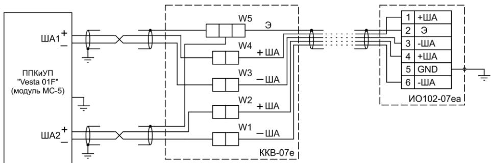
**Рисунок 7 - Подключение извещателей ИО102-07ea в кольцевую АЛС “ША” ППКиУП “Vesta 01F” или модуля “MC-5” с помощью коммутационной коробки ККВ-07е.**
